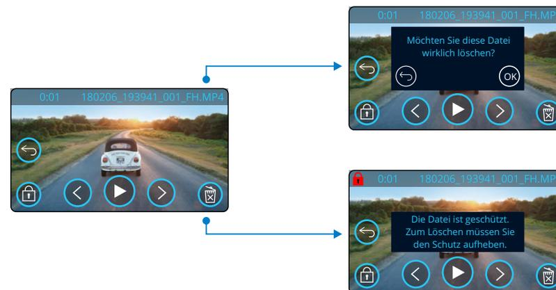
Tippen Sie im Vorschaumodus auf Löschen, um eine Datei zu löschen. Ist die Datei geschützt, dann wird die Mitteilung „Datei ist geschützt. Heben Sie den Schutz zum Löschen auf“.
