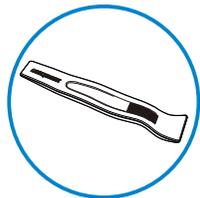
Verwenden Sie das Kabelverlegewerkzeug, um das Stromkabel in der Verkleidung Ihres Fahrzeugs zu verlegen.
