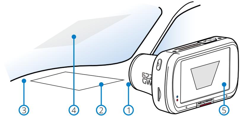
Drehen Sie die Blende vorsichtig, um den Filter einzustellen. Drehen Sie den Filter, bis die Reflexion der Windschutzscheibe auf dem Dashcam-Display nicht mehr sichtbar ist (siehe unten).
