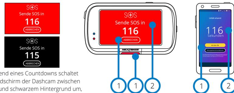
Während eines Countdowns schaltet der Bildschirm der Dashcam zwischen rotem und schwarzem Hintergrund um, um so auffällig wie möglich zu sein.
